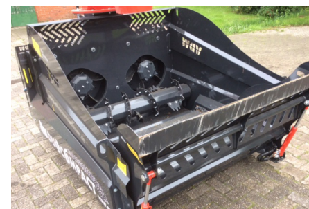
hydraulische Ladeklappe und patentiertes Doppelwurfgebläse (Duo)
