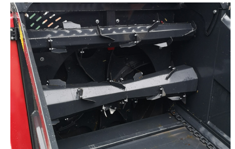
2 hydraulisch angetriebene Auflösewalzen und hydraulischer Kratzboden
