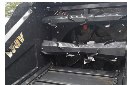
2 hydraulisch angetriebene Auflösewalzen mit hydraulischem Kratzboden
