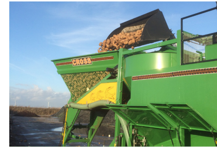
Annahembunker, trockene Vorreinigung
