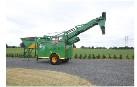
Überladehöhe 3650 mm mit Schnitzelwerk
