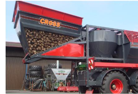
Annahmebunker, patentierter Entsteinungszyklon und Waschtrommel
