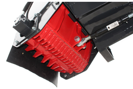
stufenlose Einstellung der Schnitzelgröße
