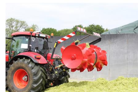
Schutzbügel mit Reflektorfolie
