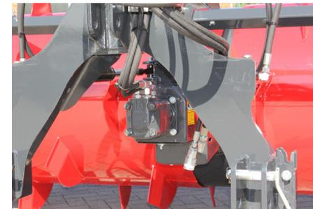
Antrieb über Danfoss Industriemotor, optional
