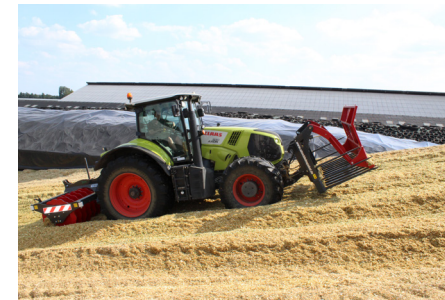
Abschiebevorrichtung ist gleichzeitig Zinkenschutz
