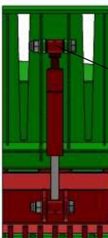
1. Bolzen entfernen und den Zylinder von der Maschine lösen
