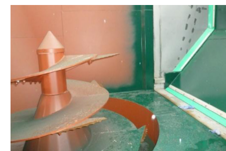
angekoppelter Mischer mit 400 mm Abbruchkante
