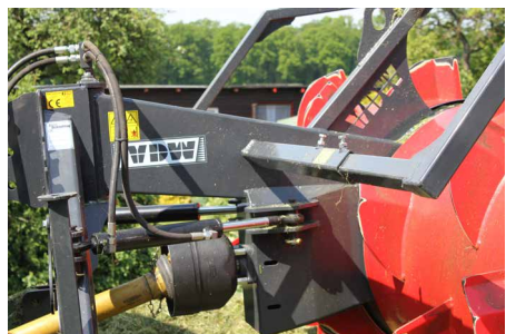
Drehgelenk im Koppeldreieck (keine Weitwinkelgelenkwelle erforderlich)
