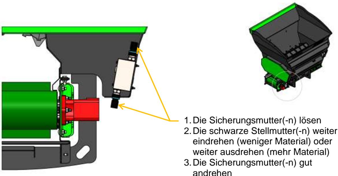
Optional kann auch die Geschwindigkeit des Ausgabebands geregelt werden. Durch Ein- oder Ausdrehen der schwarzen Knöpfe am Durchflussverteiler wird die Geschwindigkeit des Ausgabebands erhöht oder reduziert. Die Geschwindigkeit des Ausgabebands kann unabhängig voneinander nach links oder rechts eingestellt werden.
