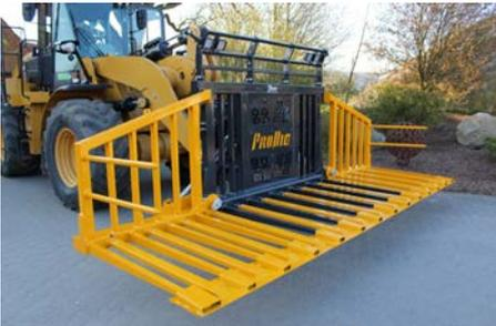
Rückwandgitter mit geschraubtem Fenster für Z Kinematik
