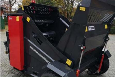
gezogene Ausführung mit hydr. Heckklappe
