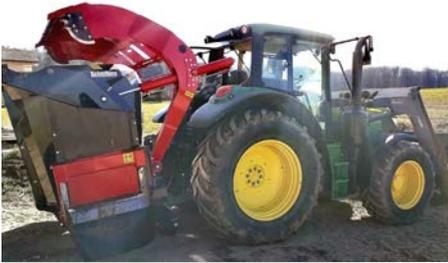
Mini Mix DPK mit Schneidstanze
