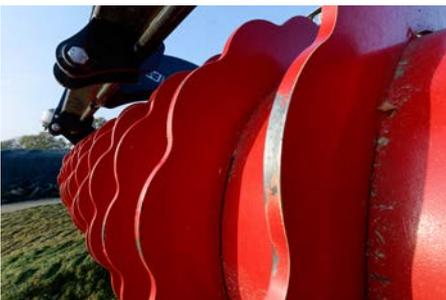
sicheres Walzen durch Wellenprofil
