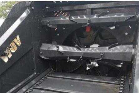
2 hydraulisch angetriebene Auflösewalzen
