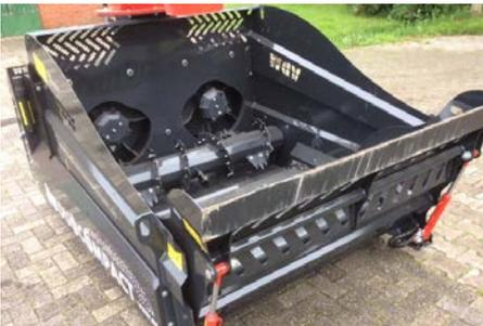
hydraulische Ladeklappe und patentiertes Doppelwurfgebläse (Duo)
