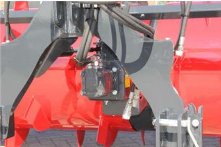
Antrieb über Danfoss Industriemotor,
