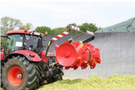
Schutzbügel mit Reflektorfolie
