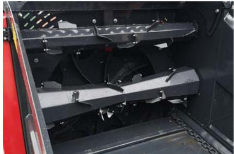
2 hydraulisch angetriebene Auflösewalzen und hydraulischer Kratzboden
