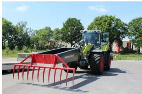
12 sichelförmige Zinken aus Hardox 450
