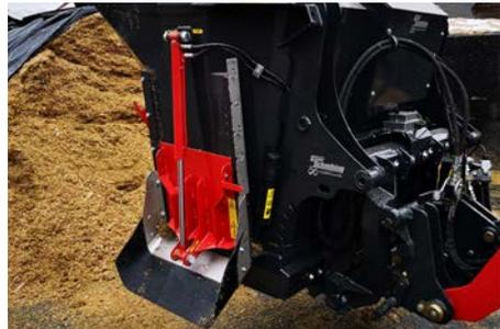
Austrag über hydraulisch betätigte Türen
