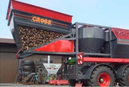
Annahmehunker, patentierter Entsteinungszyklon und Waschtrommel
