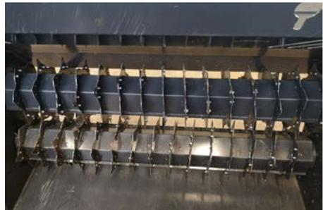
2 hydr. angetriebene Auflösewalzen mit 1/2 Satz Auflösmessern
