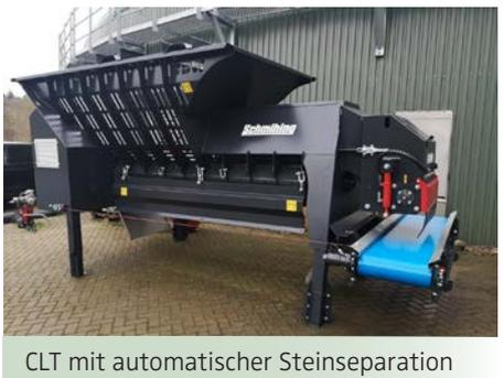
CLT mit automatischer Steinseparation
