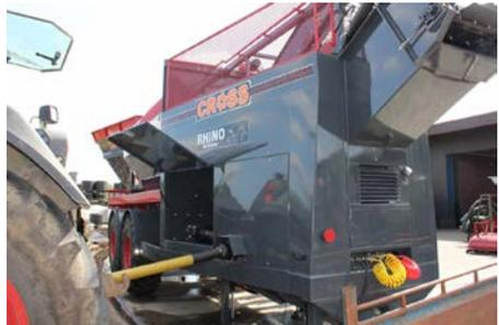
Antrieb über Gelenkwelle und 1 EW-Steuergerät
