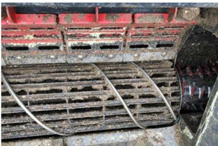
Reinigungsgitter mit Fremdkörperschutz
