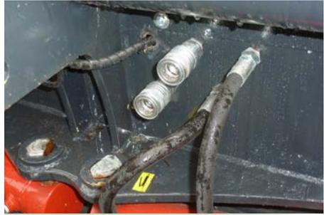
hydraulischer Anschluss für Oberlenker bei elektrohydraulischer Bedienung
