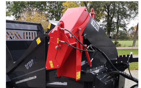
Hurricane mit schwenkbarem Auswurf 45°
