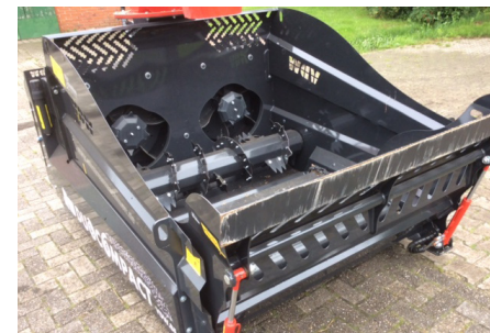
hydraulische Ladeklappe und patentiertes Doppelwurfgebläse (Duo)
