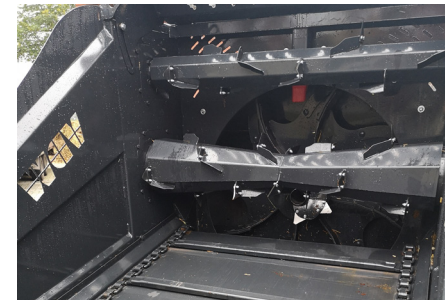
2 hydraulisch angetriebene Auflösewalzen mit hydraulischem Kratzboden
