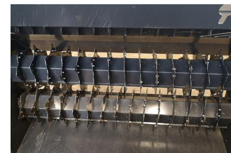
2 hydr. angetriebene Auflösewalzen mit 1/2 Satz Auflösemessern
