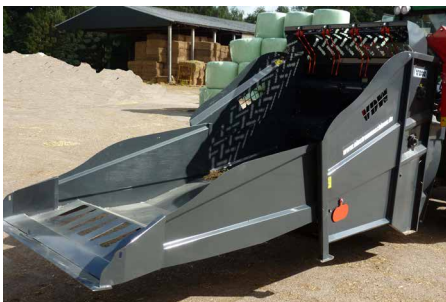
groß dimensionierte hydr. Ladeklappe
