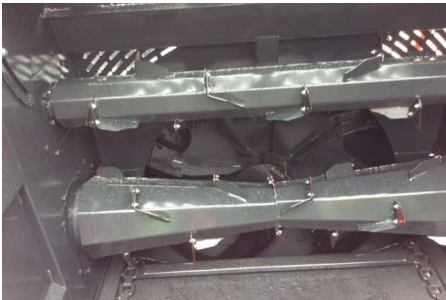
2 hydraulisch angetriebene Auflösewalzen hydraulischer Kratzboden
