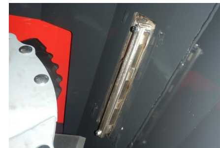
hochwirksame Magnetabscheidung metallischer Fremdkörper - optional
