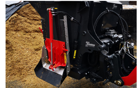
Austrag über hydraulisch betätigte Türen mit flexibler Austragsrutsche
