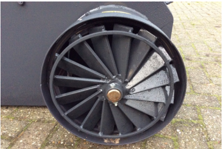
abnehmbare Schneidvorrichtung für Rüben + Kartoffeln
