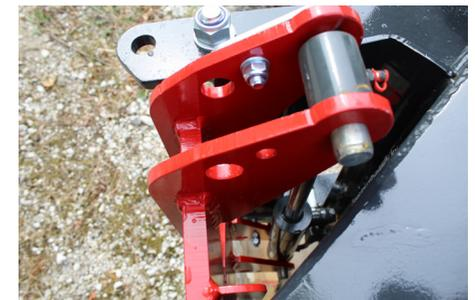
doppelwirkende hydraulische Zylinder
