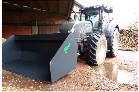
hochverschleißfester Unterbau Hardox 450 HB
