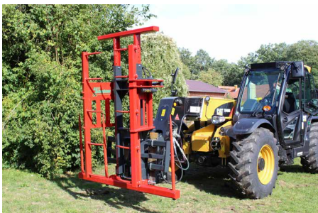
klappbarer Gabelträger für den Straßen-transport
