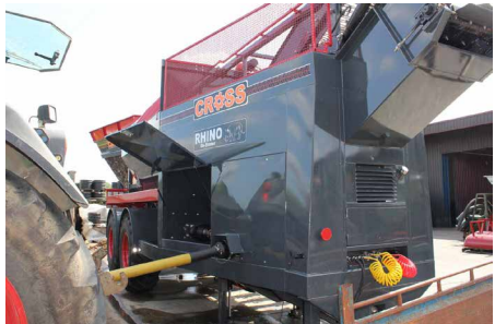
Antrieb über Gelenkwelle und 1 EW-Steuergerät
