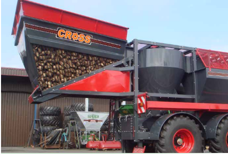
Annahmehunker, patentierter Entsteinungszyklon und Waschtrommel
