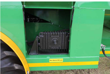
Antrieb über Gelenkwelle + 1 EW-Steuergerät
