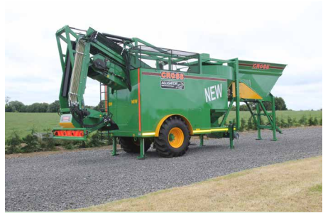
hydraulisch klappbares und zuschaltbares Schnitzelwerk
