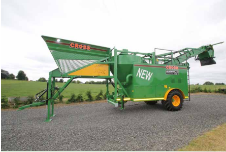
Annahmehöcker, patentierter Entsteinungszyklon
