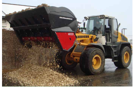
RS 3000 verarbeitet 3 Tonnen in ca. 1 min.
