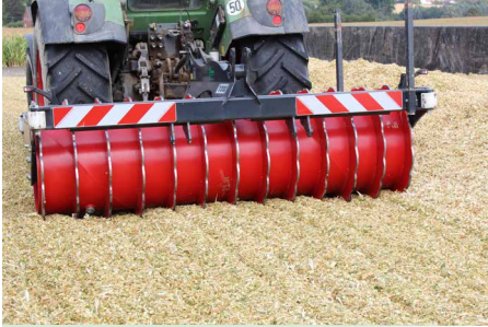
optimale Tiefenverdichtung auch bei Schredlage
