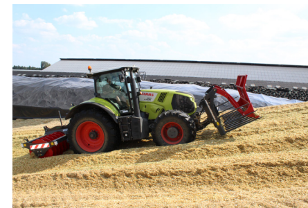
Abschiebevorrichtung ist gleichzeitig Zinkenschutz
