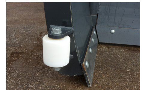
geschraubte Schürfleiste und Kunststoffrollen als Anfahrerschutz
