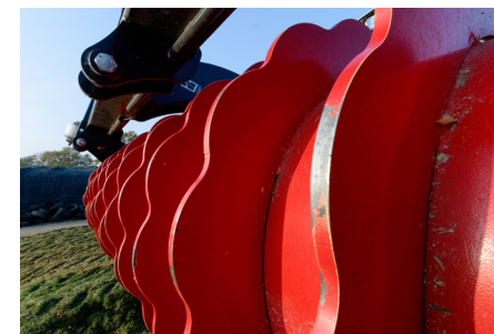
hohe Punktbelastung durch Wellenprofil
