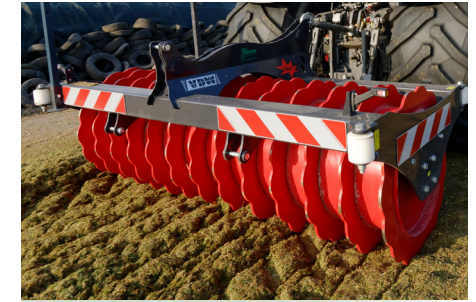
Kunststoffrollen an den Ecken zum Schutz der Silowände
