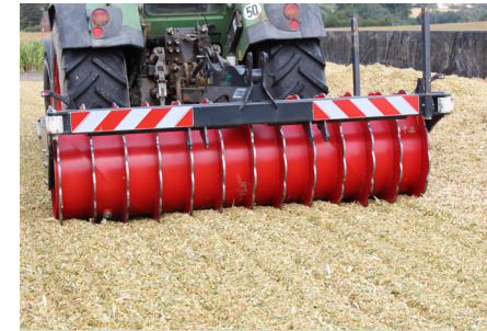
optimale Tiefenverdichtung auch bei Schredlage
