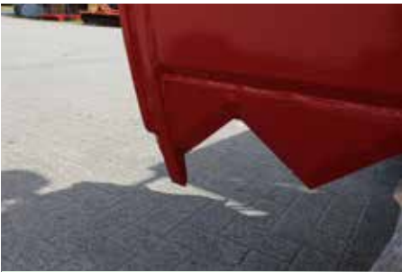
Eckzähne verhindern Beschädigung der Messer
