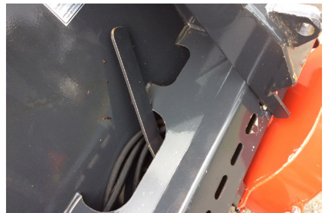
Mengenregulierung über Dosierschieber
