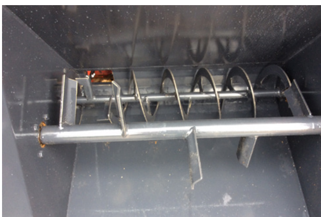
Austragsschnecke und Rührwelle
