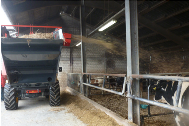
Auswurf bis zu 18 m beim Hurricane H (modell- und leistungsabhängig)
