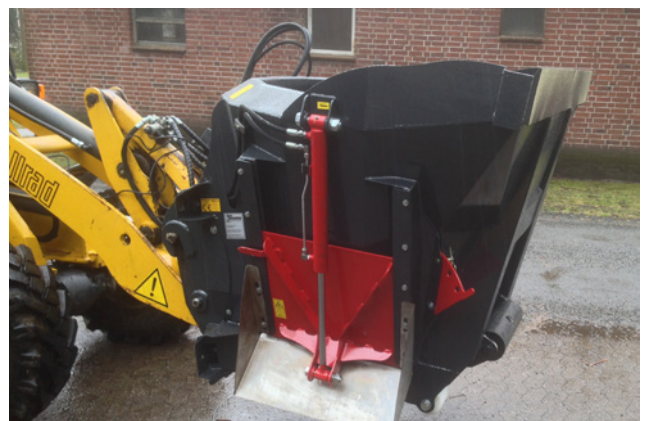
1 DW-Steuergeräte u. 1 druckloser Rücklauf
