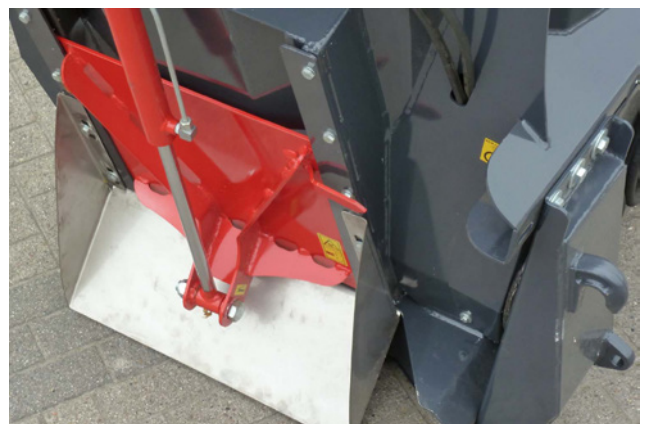
Austrag über hydraulisch betätigte Türen
