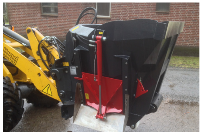
1 DW-Steuergeräte u. 1 druckloser Rücklauf
