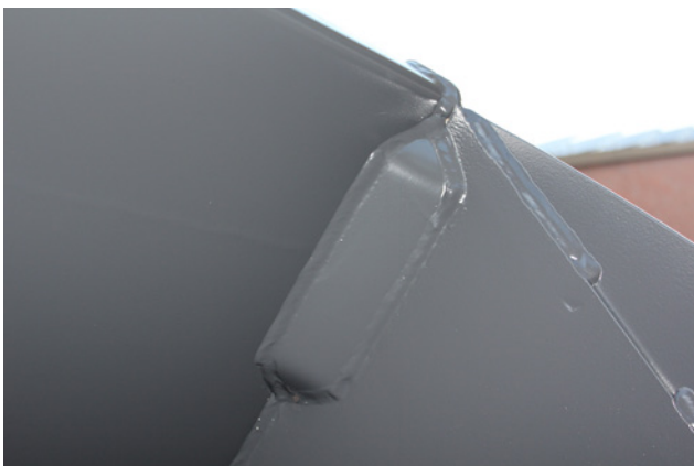
Verstärkungen in allen vier Ecken
