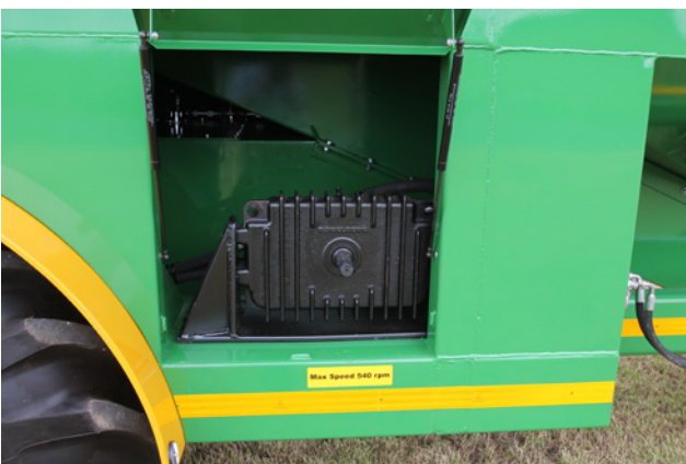
Antrieb über Gelenkwelle + 1 EW-Steuergerät
