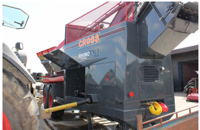
Antrieb über Gelenkwelle und 1 EW-Steuergerät
