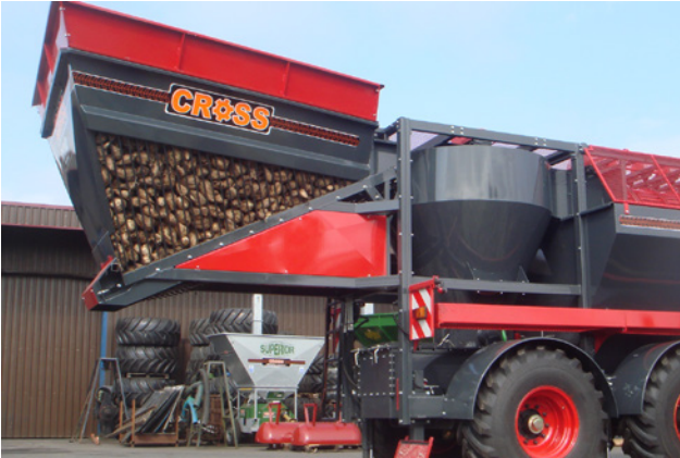
Annahmehunker, patentierter Entstei- nungszyklon und Waschtrommel
