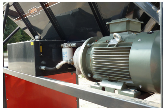
elektrohydraulischer Antrieb 30 KW/63 A
