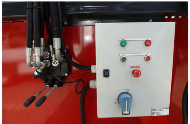
Bedienung und Überlastsicherung bei elektrohydraulischer Ausführung
