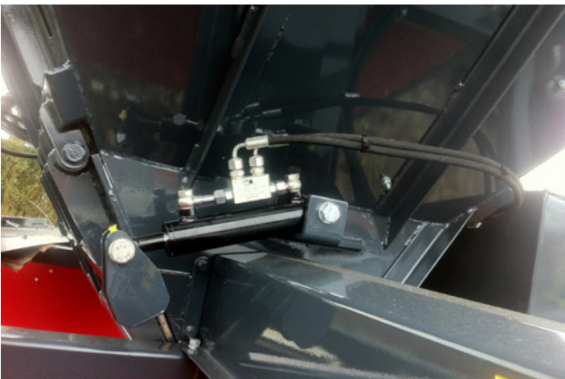
hydraulisch einstellbare Gegenschneide
