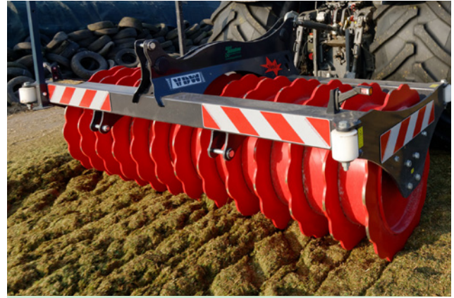
Kunststoffrollen an den Ecken zum Schutz der Silowände
