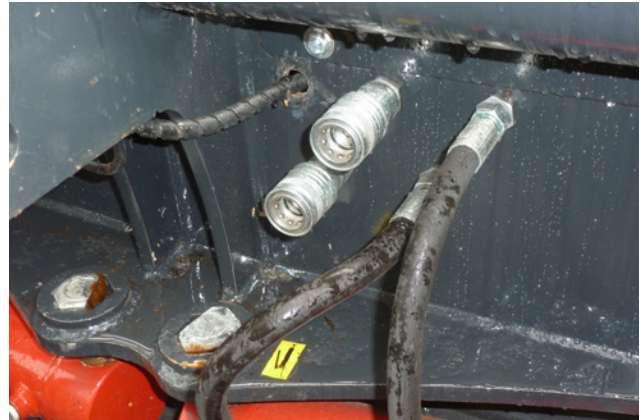
hydraulischer Anschluss für Oberlenker bei elektrohydraulischer Bedienung
