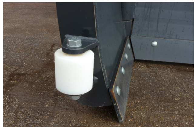
geschraubte Schürfleiste und Kunststoffrollen als Anfahrerschutz
