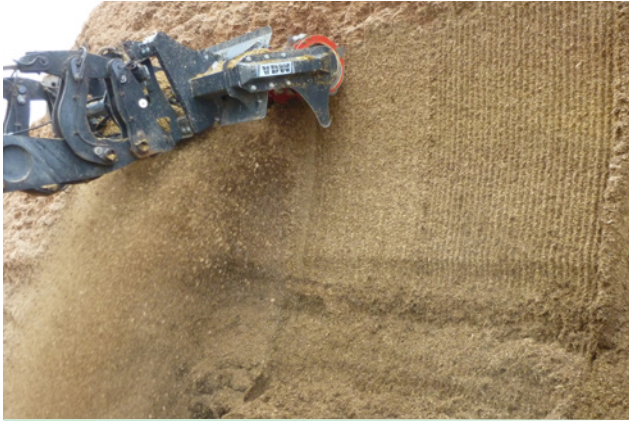
geringe Verluste durch glatte Silowände
