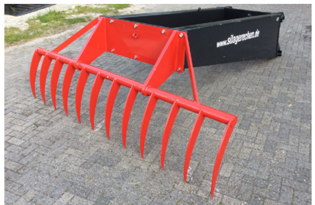
12 sichelförmige Zinken aus Hardox 450
