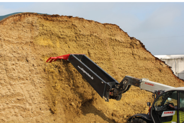
schält die Silage leicht und zügig aus dem Silostock (SR 4030 bei der Arbeit)
