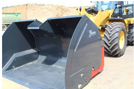
gerundeter Schaufelboden und Ausschnitt für Z-Kinematik
