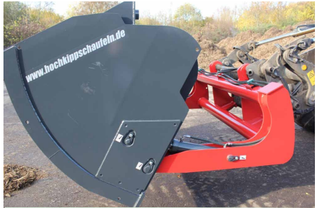
Zylinder geschützt in Seitenwange
