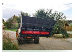
Gegenschneiden mit stufenloser Spindelverstellung
