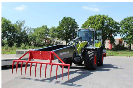
12 sichelförmige Zinken aus Hardox 450
