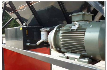
elektrohydraulischer Antrieb 30 KW/63 A
