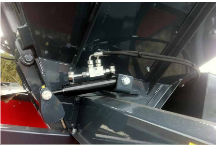
hydraulisch einstellbare Gegenschneide
