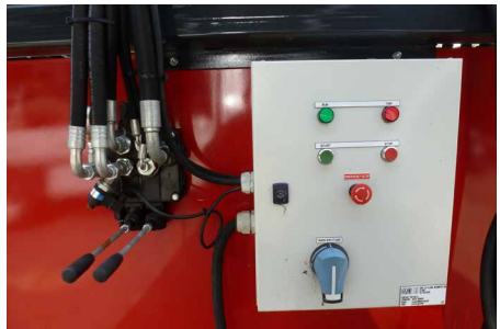
Bedienung und Überlastsicherung bei elektrohydraulischer Ausführung
