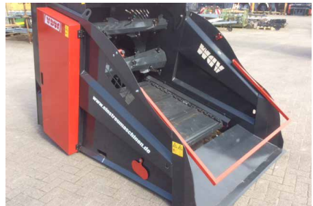
2 hydraulisch angetriebene Auflösewalzen hydraulischer Kratzboden (nur bei Hurricane H)
