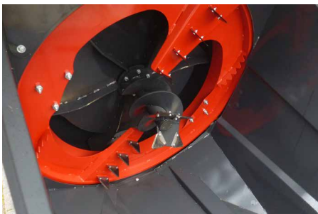
Auflöserotor beim Hurricane H Mini
