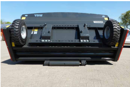
schonendes Beladen über Bodenrolle, exaktes Dosieren über Tasträder
