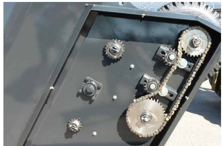
Geschwindigkeits- und Mengendosierung über Wechselkettenräder
