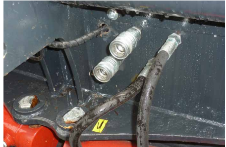
hydraulischer Anschluss für Oberlenker bei elektrohydraulischer Bedienung
